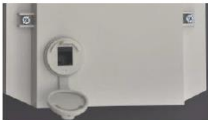
Abbildung 1: Der Anschlussstecker der Verbraucherinformationsschnittstelle ist ein RJ12-Stecker, bei dem nur die Stifte 3 und 4 aktiv sind. Die Schnittstellenabdeckung kann nach dem Schliessen plombiert werden.
